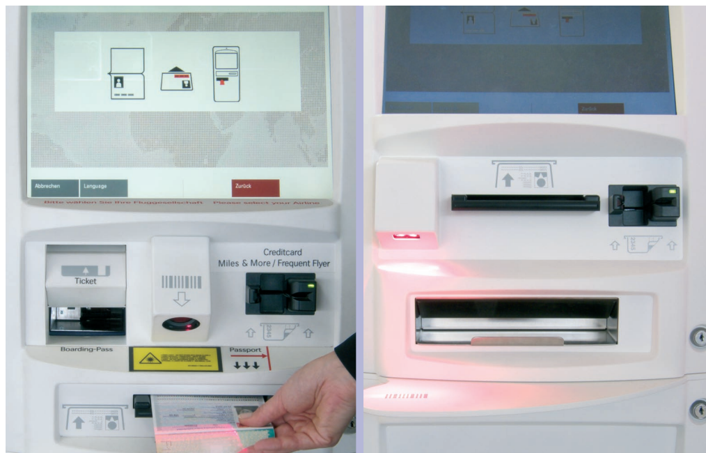
Nicht wirklich vertrauenserweckend: der alte Automat mit Laserkanone und Warntafel. Daneben die entschärfte, neue Version, mit klarer verständlichen Schnittstellen.
